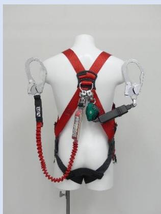
落下距離を小さく抑えられる巻取式ランヤードを作業用として、伸縮ストラップ式は盛り替え用としてご使用いただけます。
