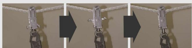
万が一墜落した場合も、安全滑車に荷重がかかれればロック機構が作動！
